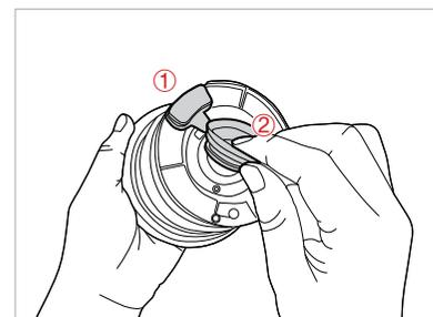
Die Silikondichtung lässt sich zur Reinigung herausnehmen. Setzen Sie die Dichtung wie auf dem Bild gezeigt wieder ein, achten Sie dabei auf korrekten Sitz.
