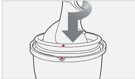
**Hinweis** | Die Presswalze muss richtig eingesetzt sein, damit der Einfüllschacht schließt.
