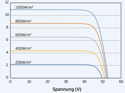
**P-V KURVEN DES PV-MODULS (450 W)**
