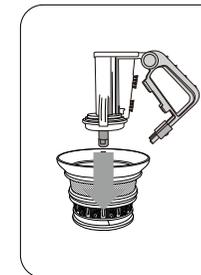
Die Befestigungsstange wird in die Silikonringnut in der Mitte des Siebes abgesenkt.
