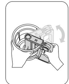
Von Seite zu Seite waschen. Dabei das Doppelreinigungswerkzeug und das Sieb unter fließendem Wasser in entgegengesetzte Richtung drehen.
