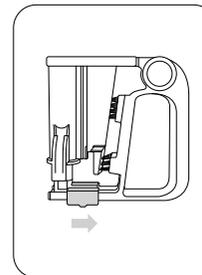
Zum Lösen des Doppelreinigungswerkzeugs den Schiebeverschluss in Richtung des Griffs drücken.
