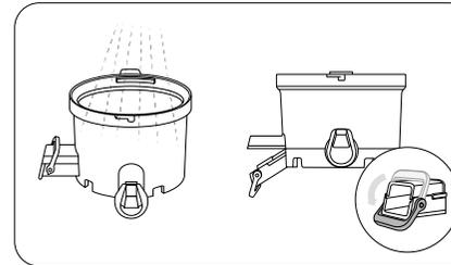
Die Verriegelung des Fruchtfleischauslasses nach unten ziehen, um sie für die Reinigung zu entriegeln.
