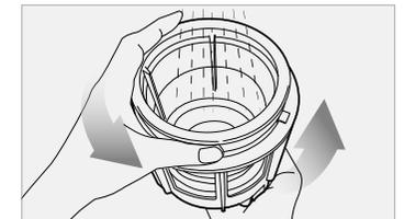
**4** Entfernen Sie den Reiniger vom Sieb nach der Reinigung. Vor der Lagerung trocknen.
