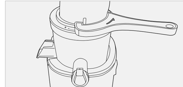
2 Fassen Sie das Einfüllrohr und drehen Sie den Deckelöffner gegen den Uhrzeigersinn.
