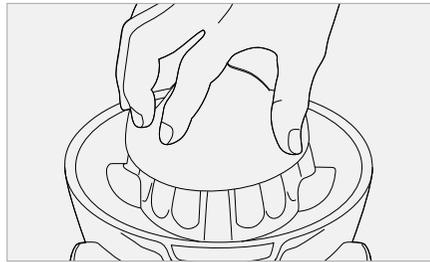
4 Reinigen Sie die Presskegel und das Sieb, wenn der Fruchtfleischanteil zu hoch ist.
