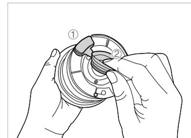
Die Silikondichtung lässt sich zur Reinigung abnehmen. Setzen Sie die Dichtung, wie auf dem Bild gezeigt, wieder ein, achten Sie dabei auf das richtige Einrasten.
