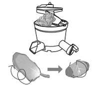
Wenn sich die blättrigen Zutaten um die Saftschnecke verheddern, öffnen Sie den Deckel und entfernen Sie die Fasern, bevor Sie mit dem Entsaften fortfahren.
