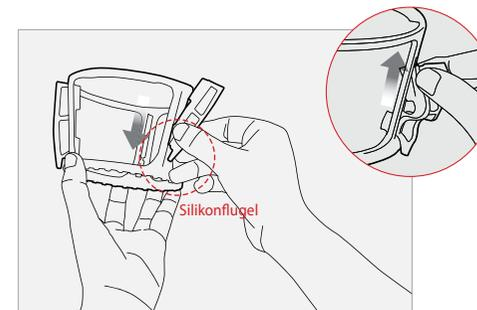
TIPP | Setzen Sie den Silikonflügel ein, ausgerichtet mit dem kurzen Ende nach unten.
