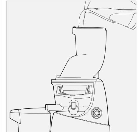
**2** Öffnen Sie das Smart Cap nach einigen Umdrehungen und lassen Sie das Wasser in den Saftbehälter laufen.
