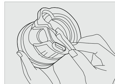
Die Silikondichtung lässt sich zur Reinigung abnehmen. Setzen Sie die Dichtung wie auf dem Bild gezeigt wieder ein, achten Sie dabei auf korrekten Sitz.
