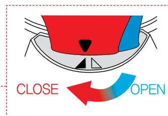
Richten Sie die Pfeilmarkierung ▼ auf dem Deckel an der Open-Markierung des Motorblocks aus und drehen Sie den Entsaftungs-Aufsatz im Uhrzeiger-Sinn bis die Pfeilmarkierung des Deckels mit der ▲ Close-Markierung übereinstimmt.
